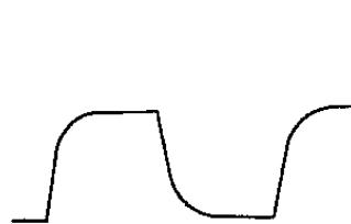
Obr. 25. Zkreslený tvar obdélníkových impulsů způsobený lineárním zkreslením v oblasti horních kmitočtů (velké  $L_u$ )
